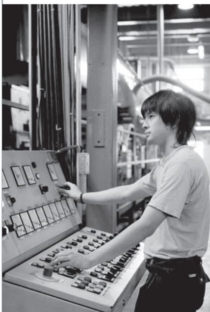
捺染された生地を蒸すことにより染料を発色・定着させ、その後余分な糊などを洗い落とします。自社では高い処理能力をもつイタリア製の設備を用い作業の効率化を図っています。
