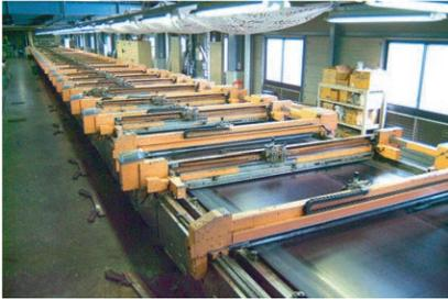
自社が国内の機械メーカーに完全特殊仕様で制作してもらった超スーパー捺染機です。2メートル以上リピートの柄が可能なので大きなモチーフにも楽々対応。しかも24色もの表現を掛け合わせればプリントの表現は従来の常識をはるかに覆す広がりをお約束します。メイドインジャパンの信頼性は他に類を見ないニッポンが誇る超進化系のサムライといっても良いでしょう。仕上がりの高さだけでなく対応力の大きさも『ものづくり』の重要な要素のひとつです。
