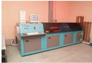
ロータリースクリーン用レーザー露光型ダイレクト彫刻機
