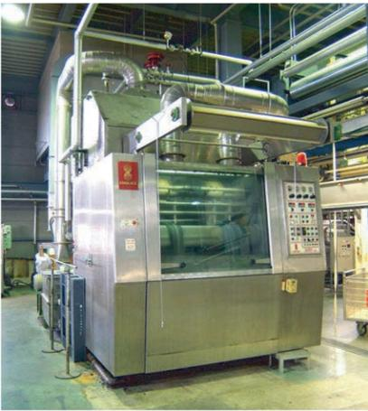
最終工程でプリントした生地に表情や柔らかさを与え風合いを出すための国内でも希少なイタリア製のマシンです。内部が特殊なエアフロー構造になっていてプリント生地に“もみ”効果を与えることにより製品にしたときの着心地感をアップさせます。布に色を染める、だけが私たちの仕事ではありません。徹底した高品質な商品へのこだわりはこういった細かな作業から生み出されます。
