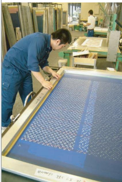
配色カードに基づいて、サンプル(マス)を作成します。実際の型を用いて生地にプリントし、柄の出方、色を確認します。量産する前の段階として、このサンプルであらゆる問題点を見出し、スムーズに加工できるように最終調整していきます。
